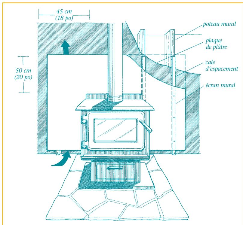
▲ VUE EN COUPE D'UN ÉCRAN MURAL – En permettant à l'air de circuler entre l'écran et la surface combustible, l'écran mural peut servir à réduire le dégagement minimal en toute sécurité. L'écran doit se prolonger d'au moins 50 cm (20 po) au-dessus de l'appareil et de 45 cm (18 po) au-delà de chacun des bords de l'appareil.
