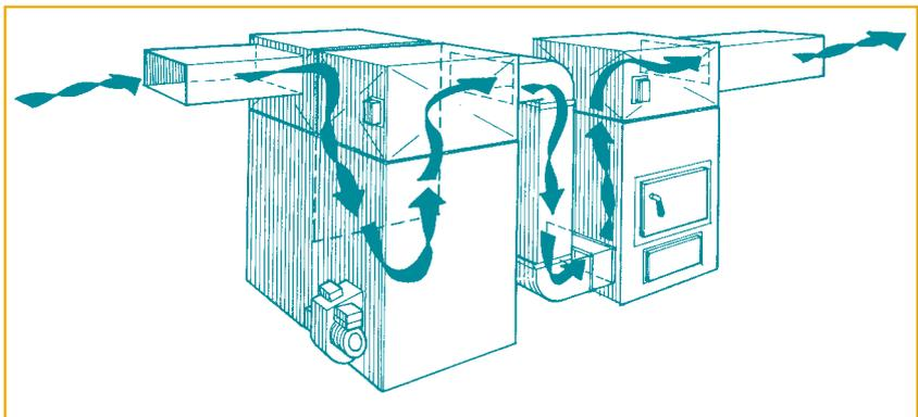
▲ L'appareil d'appoint se place à côté du générateur existant et les deux sont raccordés par des conduits spéciaux. L'air circule par le générateur principal puis par le générateur d'appoint avant de parvenir aux conduits qui le répartissent dans la maison. L'installation de générateurs d'appoint doit être confiée à des professionnels compétents.
