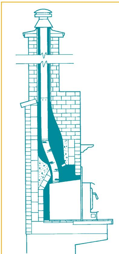
▲ *Les codes municipaux d'installation exigent maintenant l'installation d'un chemisage en acier inoxydable raccordant la buse du foyer encastrable à la partie supérieure de la cheminée afin d'accroître le rendement et la sécurité.*
