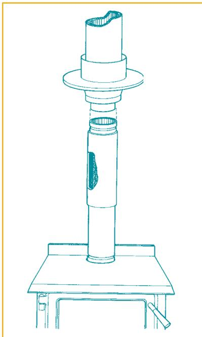
▲ **TUYAUX DE RACCORDEMENT À DOUBLE PAROI** – Les tuyaux de raccordement à double paroi certifiés comportent un chemisage intérieur en acier inoxydable et une enveloppe extérieure scellée ou ventilée. Ils sont plus coûteux que les tuyaux à simple paroi, mais ils durent plus longtemps et assurent une plus grande stabilité. Les tuyaux à double paroi peuvent normalement se placer plus près des matériaux combustibles que les tuyaux à simple paroi.
