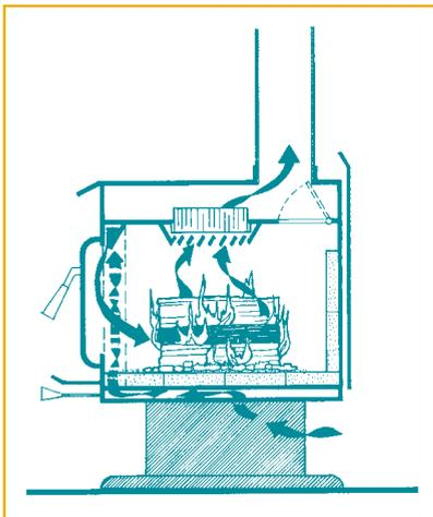
▲ Poêle à combustion catalytique
