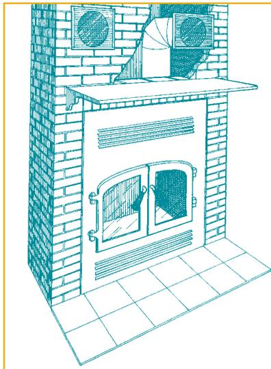
▲ Ces foyers se distinguent par une chambre de combustion perfectionnée, des portes étanches en vitrocéramique et des échangeurs de chaleur. Certains modèles comportent, en option, des conduits distribuant la chaleur vers d'autres pièces de la maison.
