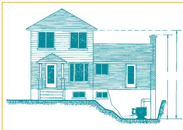
d'air » dans le sous-sol des maisons peu étanches à l'air, car l'air froid extérieur est attiré par la zone de basse pression, tandis que les pièces situées à l'étage sont plus confortables. Cette différence de pression aux divers niveaux de la maison s'appelle **l'effet de tirage**. Ce phénomène concurrence la cheminée qui dessert un appareil de chauffage installé dans le sous-sol d'une maison et peut se traduire par des émanations et des problèmes de ventilation.
