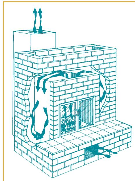
▲ Contrairement aux foyers ordinaires en maçonnerie, les corps de chauffe en maçonnerie assurent une combustion moins polluante tout en étant une source de chaleur plus efficace. La chaleur du feu se transmet à la masse de la maçonnerie avant de se diffuser lentement dans la pièce. Ces corps de chauffe n'ont pas été évalués quant à leurs émissions. Vous pourrez toutefois en obtenir un rendement équivalent en suivant les directives de la Masonry Heater Association of North America.
