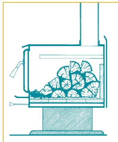
▲ **POUR ATTISER UN FEU À PARTIR DES CHARBONS ARDENTS** – Ramenez les braises vers l'avant du poêle, à l'endroit où pénètre l'air comburant. Placez des morceaux de bois sur et derrière la braise. Ouvrez complètement l'orifice d'admission d'air et laissez-le ainsi jusqu'à ce que les morceaux de bois soient bien carbonisés. L'illustration montre comment disposer les morceaux de bois pour obtenir un feu de longue durée.
